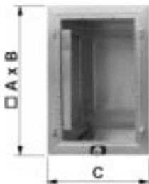
Filtre à graisse en acier fin, classe de qualité G3, s'enlevant côté opérateur. Régénérable par un nettoyage à l'eau chaude (environ 60°C) avec détergent ménager. Différence de pression finale recommandée 500 Pa.
